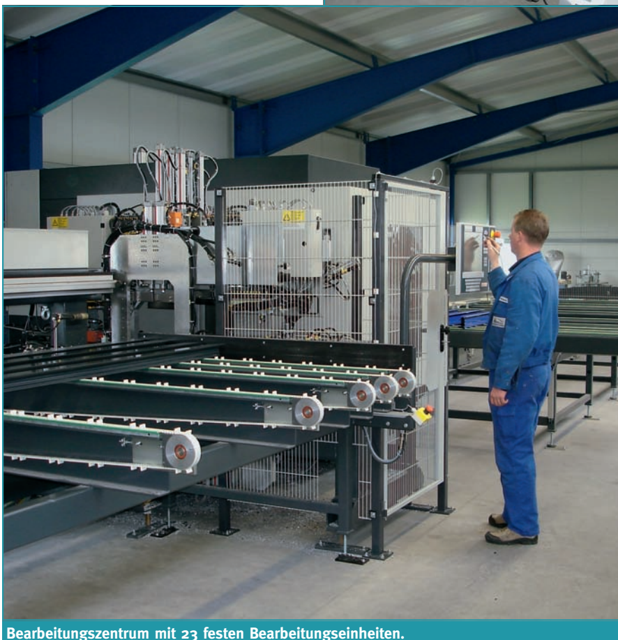
5-Achs-Sägestation und Auslauf Fotos: Wilken
