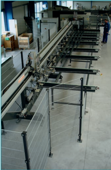
Auflage der bis zu 9,5 m langen Profile.
