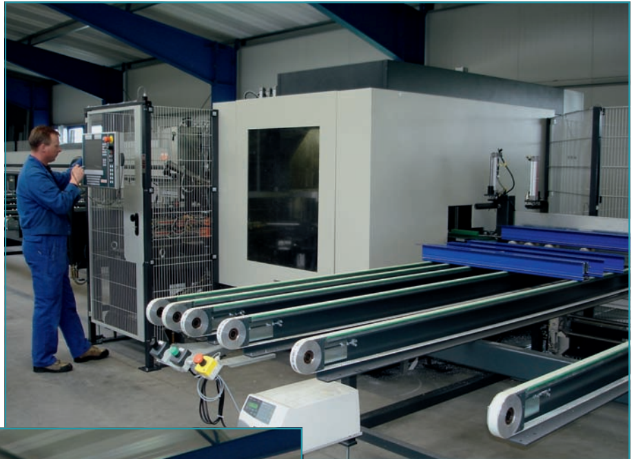
5-Achs-Sägestation und Auslauf Fotos: Wilken
